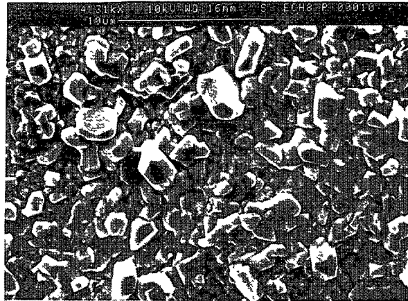
Fig. 3. — Surface de la couche de \text{Cr}_2\text{O}_3 formée sur un alliage \text{Ni}_{70}\text{Cr}_{30} oxydé sous \text{O}_2 à 900\text{ }^\circ\text{C} [7]. [Surface of the \text{Cr}_2\text{O}_3 scale formed on an \text{Ni}_{70}\text{Cr}_{30} alloy oxidized at 900\text{ }^\circ\text{C} [7].]
