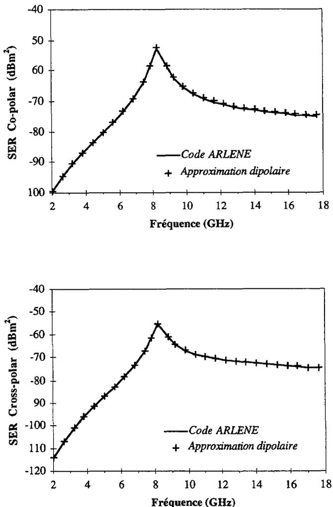
Fig. 4. — Validation de l'approximation dipolaire pour simuler un petit objet diffractant (le vecteur d'onde  $\mathbf{k}$  est perpendiculaire à l'axe de l'hélice et le champ magnétique  $\mathbf{H}$  est parallèle à l'axe de l'hélice). Caractéristiques de l'objet diffractant (hélice) :  $R = 1$  mm, Pas=1 mm,  $2a = 0,2$  mm, 2 tours à droite,  $\varepsilon = \varepsilon_0 (1,8 + j0,1)$  et  $\mu = \mu_0$ .
