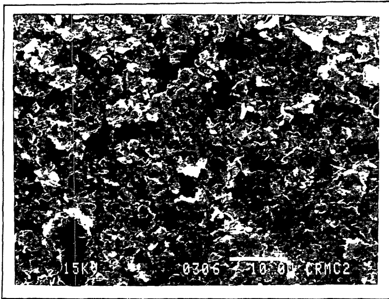
Fig. 11. — Micrographie de surface obtenue par M.E.B. d'une couche mince de \text{CuInS}_2 de type « p » avant le recuit ( x = 1,1 ; e = 0,5 \mu\text{m} ).
