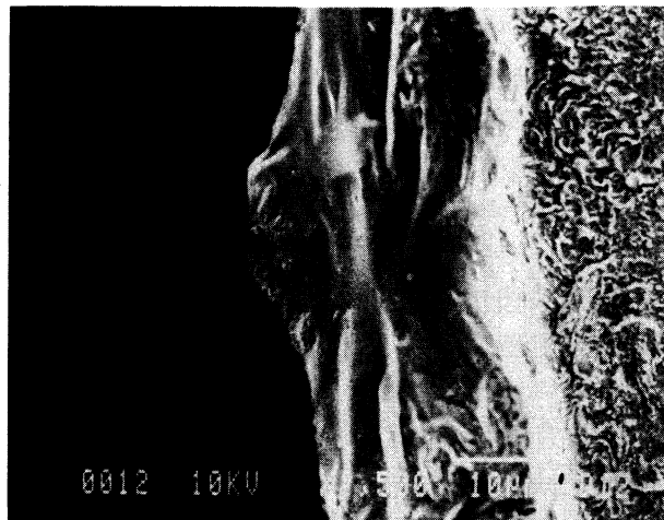
Fig. 12. — Erosion le long d'une arête d'une électrode à spirales.
