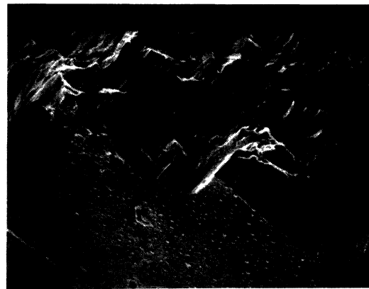
Fig. 10. — Aspect microfractographique de la surface d'une fissure 3D se propageant en stade I au voisinage du site d'amorçage dans l'alliage 7075 T651 testé sous vide.
