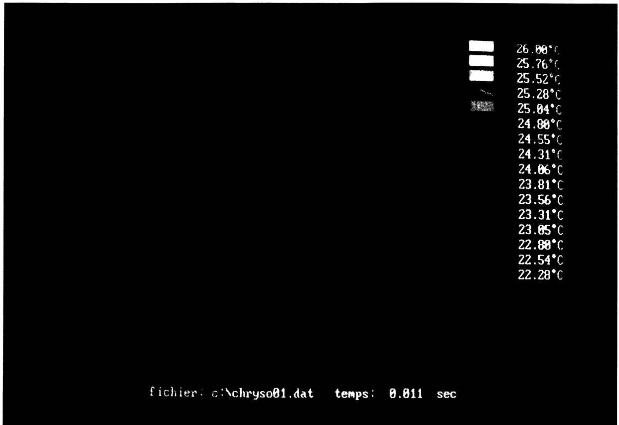
Planche 1. — L'éprouvette de duralumin est recouverte d'une fine couche de peinture noire et se détache du fond (à faible coefficient d'émissivité). L'éprouvette est à l'équilibre thermique.
