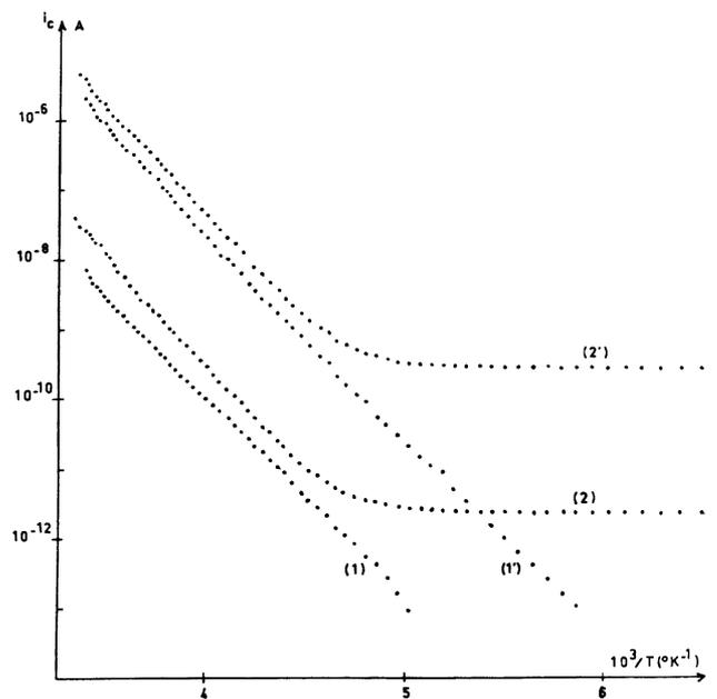
Fig. 1. — Courants de conduction en fonction de la température pour différentes tensions appliquées. (1) et (2) sous 1 V ; (1') sous 50 V ; (2') sous 100 V.
