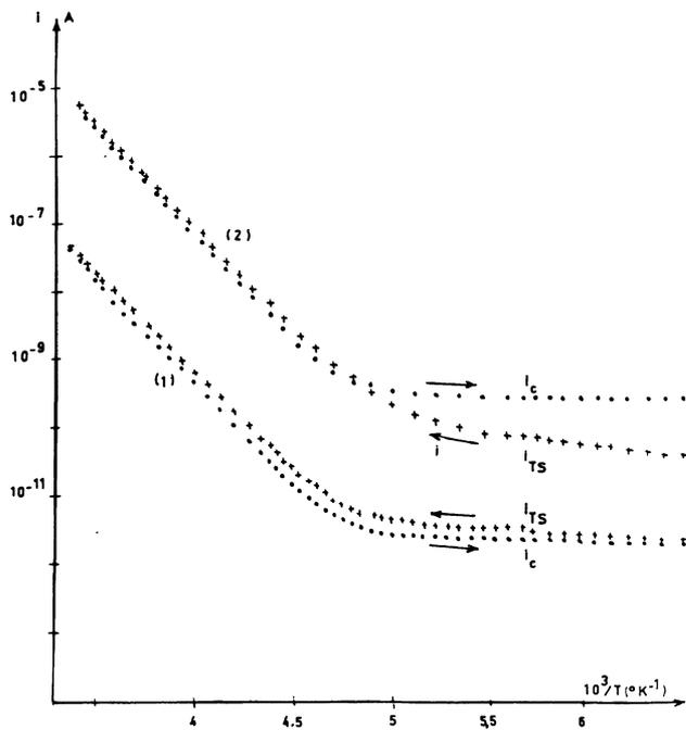
Fig. 5. — Cycles courants thermostimulés-courants de conduction. (1) :  $V = 1$  V ; (2) :  $V = 100$  V.
