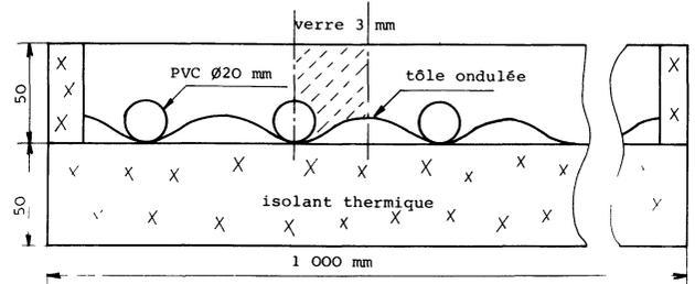
Fig. 1. — Coupe transversale du capteur expérimental.
