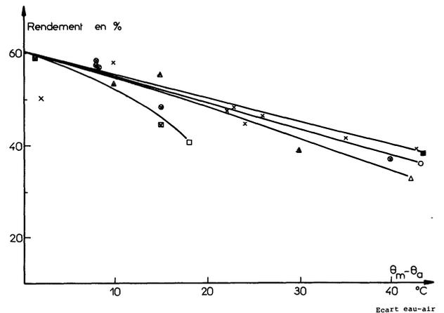
Fig. 3. — Résultats théoriques et expérimentaux concernant le rendement du capteur solaire. ■ Courbe expérimentale  $Q_s = 925 - 1040 \text{ W/m}^2$ . Points obtenus par calcul ×. ○ Courbe expérimentale  $Q_s = 810 - 925 \text{ W/m}^2$ . Points obtenus par calcul ⊙. Δ Courbe expérimentale  $Q_s = 695 - 810 \text{ W/m}^2$ . Points obtenus par calcul Δ. □ Courbe expérimentale  $Q_s = 580 - 695 \text{ W/m}^2$ . Points obtenus par calcul ⊠.
