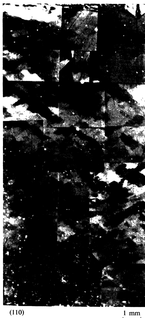
FIG. 1. — Image de la sous-structure d'un monocristal d'Au flué à 816 °C sous une contrainte de 160 g/mm 2 . \epsilon = 4,5 \% .
