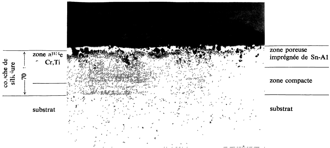
FIG. 5. — Structure du revêtement de siliciure Cr, Ti, Nb/Sn-Al après fabrication.
