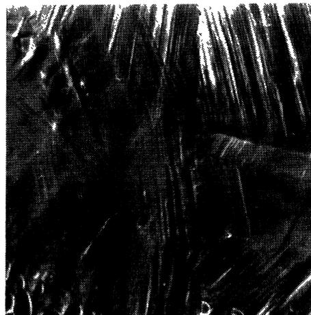
FIG. 2. — Lignes de glissement à la surface d'une austénite :  $\times 1\,000$ .
