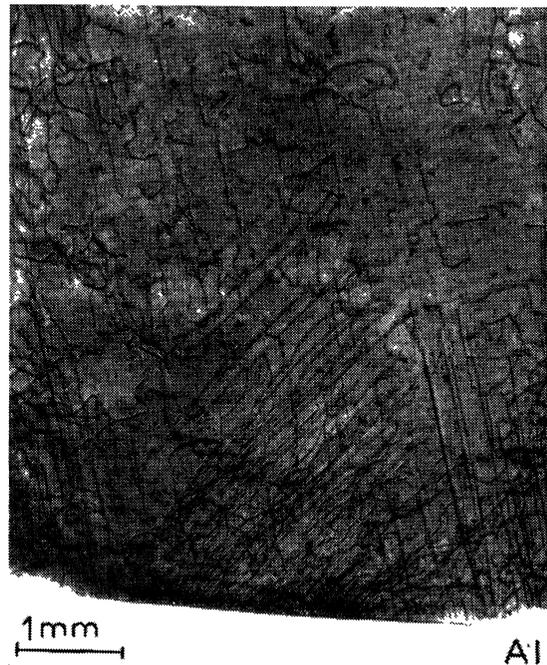
FIG. 11. — Lignes de dislocations fraîches, longues et à caractère vis apparues dans un cristal d'aluminium à la suite d'un collage à l'araldite (Frémiot *et al.*, 1968).
