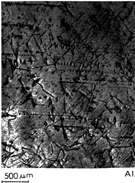
FIG. 10. — Topogramme Lang d'un cristal d'aluminium recuit sous vide (Frémiot *et al.*, 1968).
