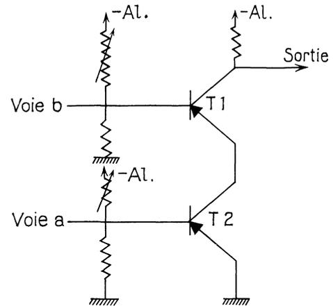
FIG. 3. — Schéma de la porte  $\bar{a}b$ .
