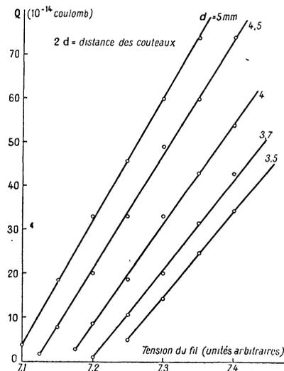
on donne la sensibilité à la charge en fonction de la tension mécanique du fil, pour diverses positions des couteaux.
