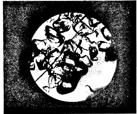
Fig. 1. — Vue microscopique des grains de sucre utilisés (Grosseur : 2 à 3 \mu ).
