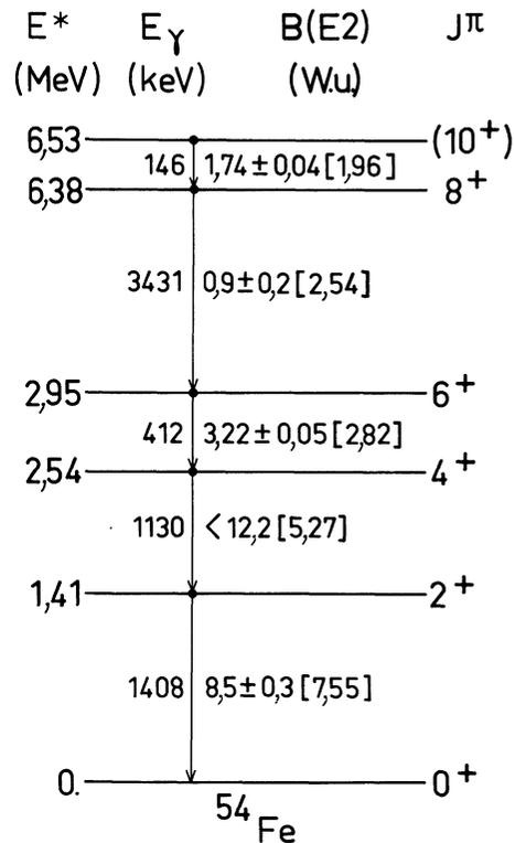
Fig. 3. — Niveaux de <sup>54</sup>Fe excités par la réaction <sup>50</sup>Cr(<sup>6</sup>Li, pn). Les valeurs B(E2), en unités Weisskopf, expérimentales et [théoriques] sont comparées entre elles.
