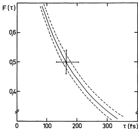
Fig. 2. — Comparaison du facteur d'atténuation théorique  $F$ , calculé en fonction de  $\tau$ , avec la valeur expérimentale. Une variation de  $\pm 20\%$  des coefficients électroniques de pouvoir d'arrêt conduit aux courbes en tiret.
