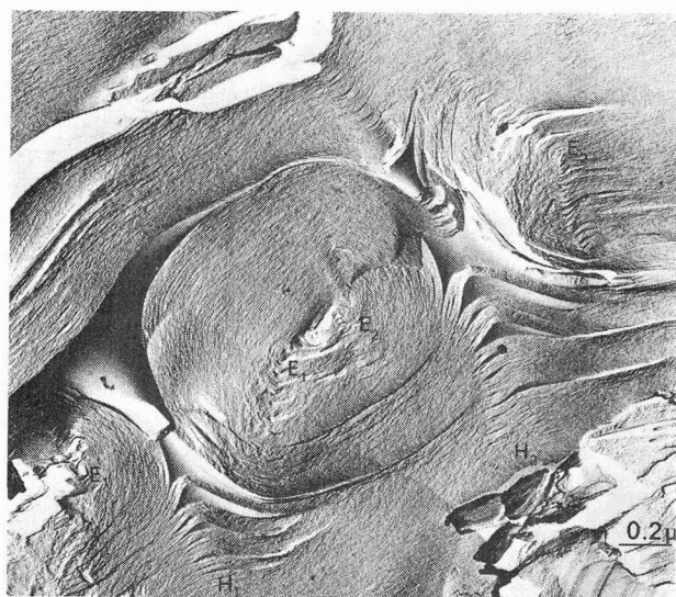
FIG. 3. — Les coniques focales. (a) Déformation des couches en cyclides de Dupin : les singularités associées sont les coniques focales : une ellipse (E) et son hyperbole conjuguée (H). (b) Observation de coniques focales associées par microscopie optique d'un échantillon thermotrope contenu entre lames de verre ; les ellipses sont dans le plan d'observation et on distingue la projection des hyperboles. (c) Observation d'un couple de coniques focales par microscopie électronique d'une réplique de cryodécapage ; les hyperboles H_1 et H_2 sont dans un plan voisin du plan de fracture ; E_1 et E_2 sont les points de percée des ellipses.
