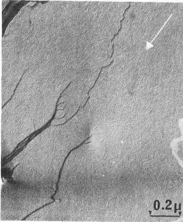
FIG. 11. — Observation de dislocations vis par cryodécoupage d'échantillons de lécithine : des rivières sont créées à partir du point d'émergence des lignes vis ; elles convergent et se propagent dans la direction d'avancée de la fracture (flèche).
