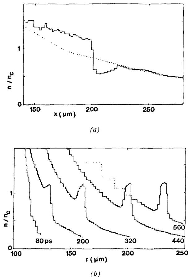
FIG. 1. — Modification du profil de densité sous l'effet de la pression de radiation (cible de DT, laser à néodyme, flux absorbé  $10^{14}$  W/cm<sup>2</sup>  $P_{\text{Laser}}/P_{\text{cinétique}} = 0,11$ ): 1 a géométrie plane; 1 b géométrie sphérique.
