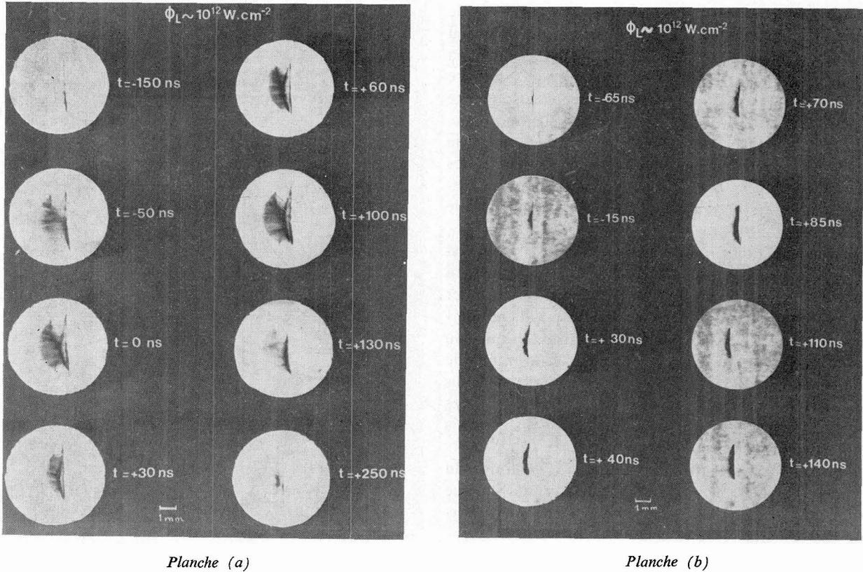
FIG. 6. — Striogrammes du plasma à différents instants : 6 a angles de déviation sélectionnés supérieurs à  $3 \times 10^{-4}$  rad ; 6 b angles de déviation sélectionnés supérieurs à  $7,7 \times 10^{-4}$  rad.
