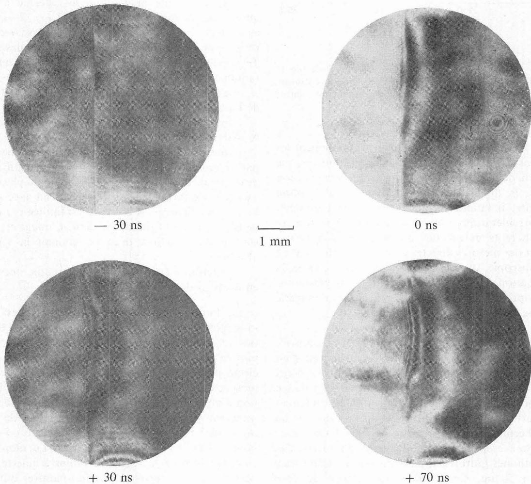
FIG. 4. — Interférogrammes du plasma à différents instants.
