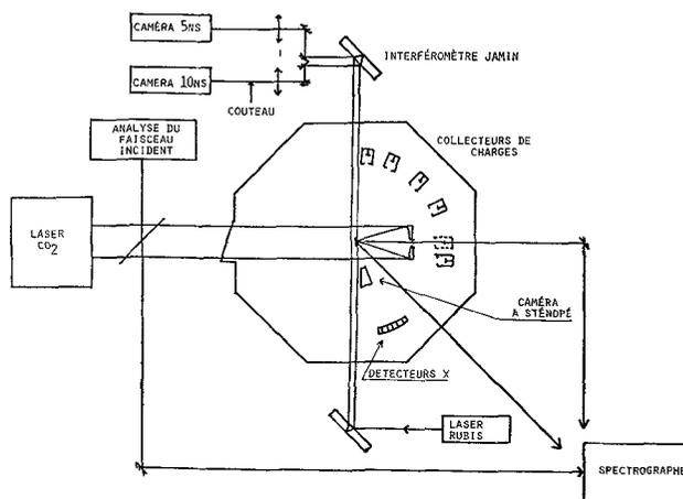
FIG. 2. — Dispositif expérimental.
