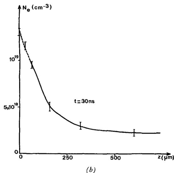
Fig. 5. — Profils de densité : 5 a représentation à trois dimensions de la densité du plasma ; 5 b profil de densité le long de l'axe du plasma.
