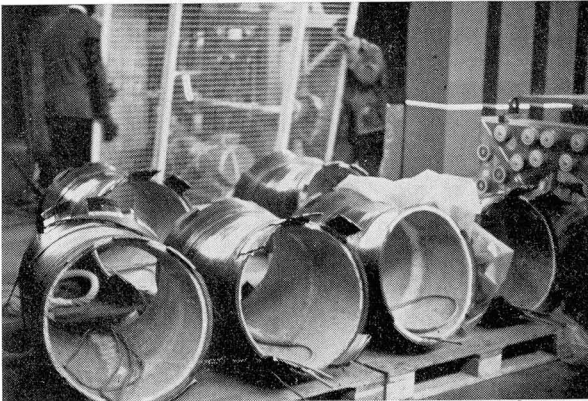
FIG. 5. — Coques en cuivre et isolation thermique (avant montage), les courants de Foucault induits dans les coques s'opposent au mouvement du plasma.
