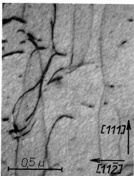
FIG. 5. — Dipoles in Fe-3 % Si alloy (A. Gemperle [9]).
