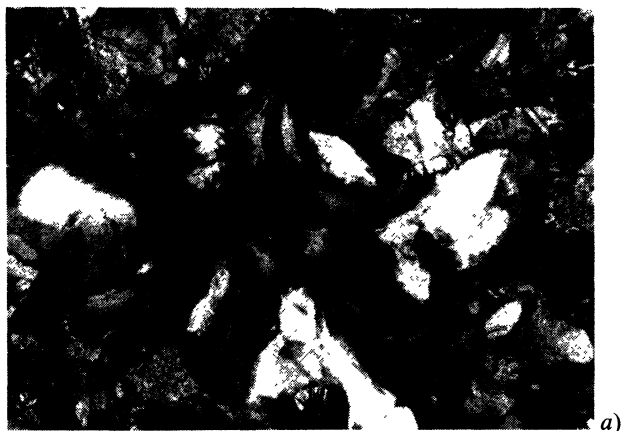
FIG. 1. — Cliché de microscopie électronique par transmission d'une couche mince AuPd, épaisseur 445 Å, concentration 6 % at. Pd.
