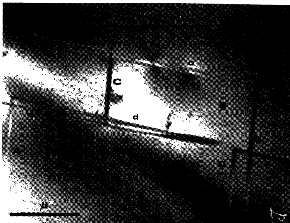
FIG. 3. — Parois d'antiphase (a, b, c, d, e) et défauts d'empilement (A, B, C, D). Champ sombre de surstructure 0112. Le plan des parois est voisin de (2\bar{1}10) .
