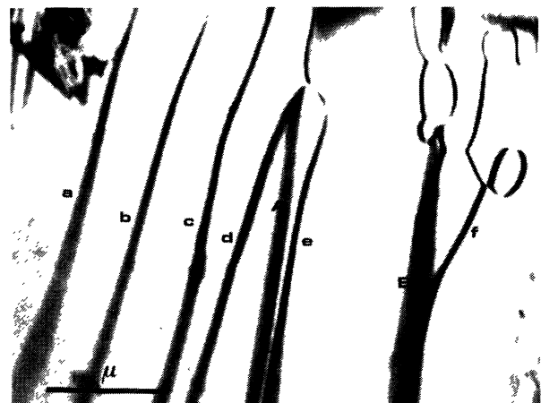
FIG. 2. — Parois d'antiphase (a, b, c, d, e, f), défauts d'empilement (A, B). Champ sombre de surstructure 0111. Le plan des parois (b et c) est voisin de (0\bar{1}10) . Parois a, c, e : \mathbf{p} = \frac{1}{2} [11\bar{2}0] ; Parois b, d : \mathbf{p} = \frac{1}{2} [1210] .
