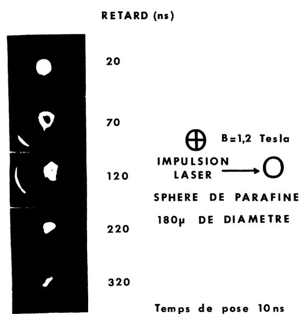
FIG. 2. — Photographies de l'arrêt de l'expansion dans un champ magnétique d'un plasma obtenu à partir d'une cible sphérique.
