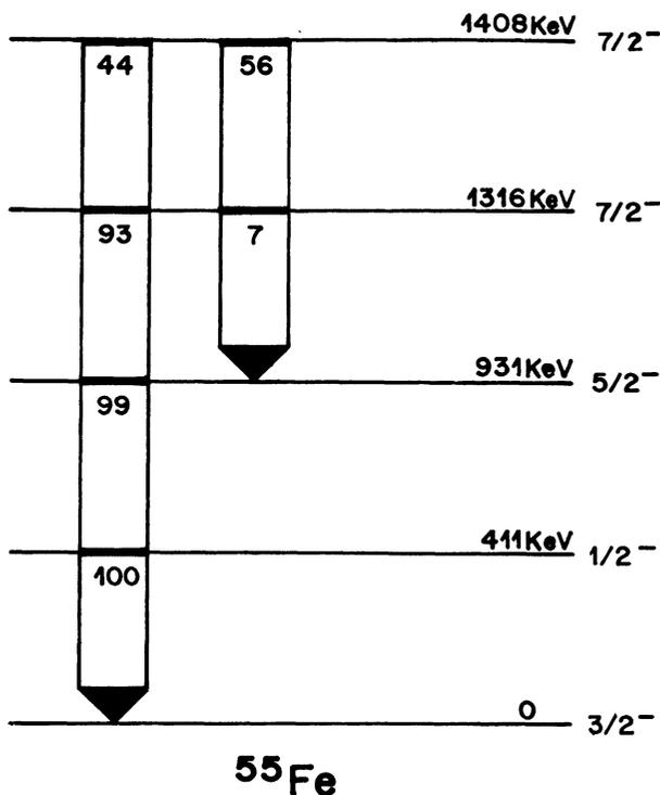
FIG. 3. — Schéma de désexcitation des premiers niveaux du noyau <sup>55</sup>Fe. Les intensités relatives sont celles reportées dans Nuclear Data Sheets [18].
