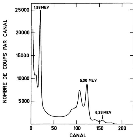
FIG. 1. — Spectre gamma à une énergie protons incidents de 5 MeV. Le pic de 1,98 MeV provient de  $^{18}\text{O}(p, p_1)^{18}\text{O}^*$ , le pic de 5,30 MeV de  $^{18}\text{O}(p, \alpha_{1,2})^{15}\text{N}^*$  (non résolus) et le pic de 6,33 MeV de  $^{18}\text{O}(p, \alpha_3)^{15}\text{N}^*$ .
