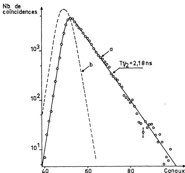
FIG. 2. — Période du premier niveau excité de  $^{40}\text{Ca}$ . Courbe *a* : courbe de coïncidences retardées  $p_1 - e$  obtenue dans la réaction  $^{40}\text{Ca}(pp')$ . Courbe *b* : courbe de coïncidences promptes  $p_3 - \gamma$  obtenue dans la réaction  $\text{Al}^{27}(pp')$ .
