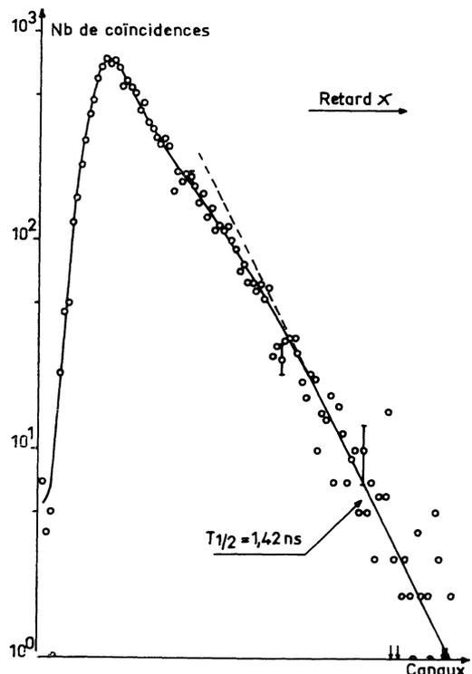
FIG. 7. — Courbe de coïncidences différés  $\beta$  — X (source de tellure 132 épurée).
