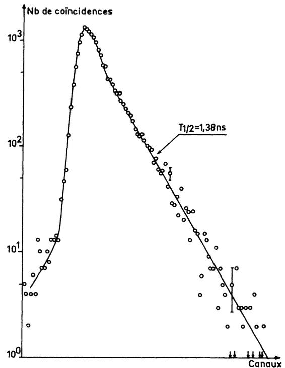
FIG. 6. — Période du niveau excité à 284 keV de l'iode 132. Courbe de coïncidences retardées  $\beta$  —  $\gamma$  232 keV.
