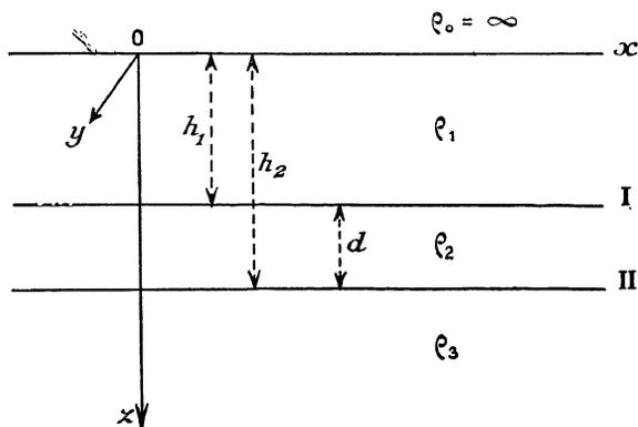
dont les résistivités sont respectivement  $\rho_1, \rho_2, \rho_3$  et dont les surfaces de séparation sont des plans parallèles indéfinis. Une électrode ponctuelle placée au point O de la surface de sépa-
