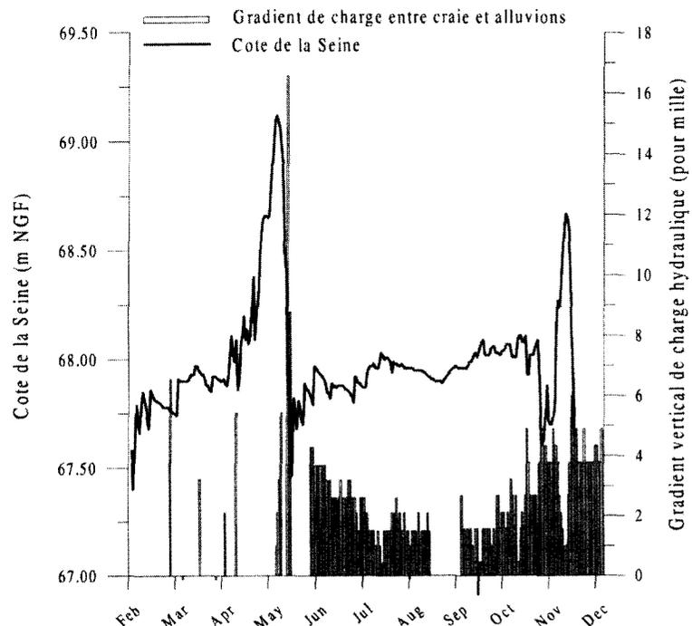
**Figure 2.** Évolution temporelle de la cote d'eau dans la Seine et du gradient vertical de charge hydraulique entre la nappe de la craie (15 m de profondeur) et la nappe alluviale (6 m de profondeur). Un gradient positif signifie « flux ascendant ».
