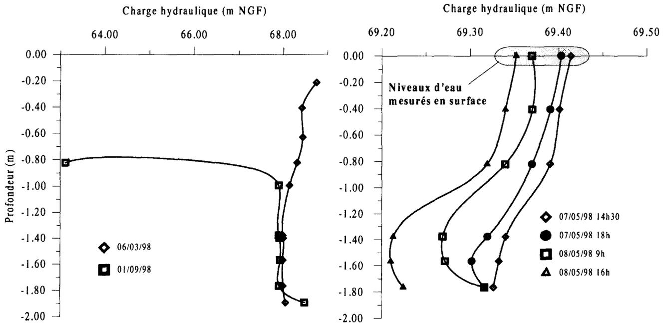
**Figure 3. Profils de charges hydrauliques (obtenus par tensiométrie et par la cote de l'eau en surface) pour des situations classiques hivernales et estivales (à gauche ; en été, les tensiomètres proches de la surface décrochent) et lors d'un suivi de décrue (à droite).**
