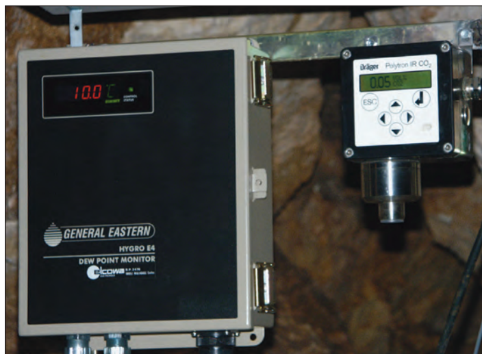
Photos 1 Station de mesures (température, hygrométrie, teneur en CO 2 ) installée dans la Salle de Joly (photos Françoise Prud'homme).
