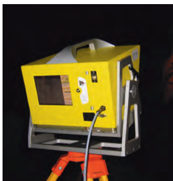
Figure 1 Mise en œuvre du lidar Optech Ilris 3D dans les Salles Rouges d'Orgnac.
