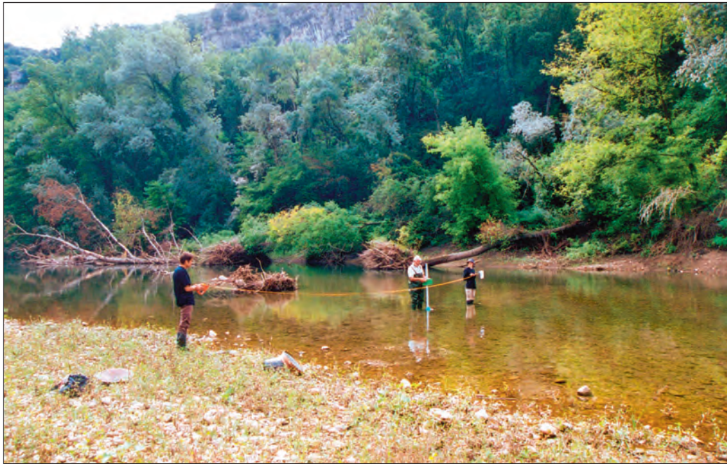
Photo1 Jaugeage de la Cèze, en amont et en aval des sources de Monteil.
