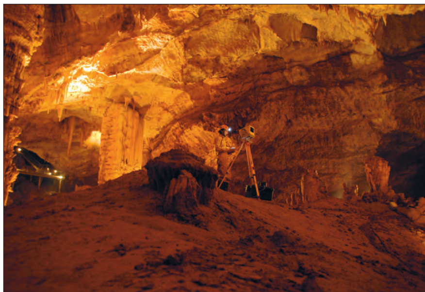
Figure 1 Mise en œuvre du lidar Optech Ilris 3D dans les Salles Rouges d'Orgnac.
