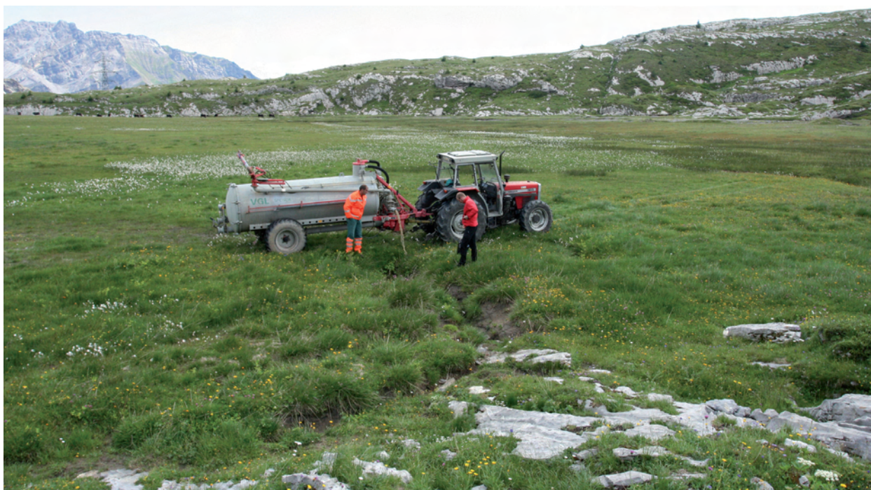
Figure 5 - Injection du traceur (tinopal) dans la perte du Plan de la Fontaine (Photo G. Favre).
