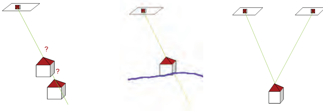
Figure 1 - Orthophoto et stéréophotogrammétrie : à gauche la localisation est impossible ; au centre la localisation est obtenue par combinaison d'une image et d'une information sur la forme de l'objet ; à droite la localisation se fait par intersection des deux droites issues de deux images.
