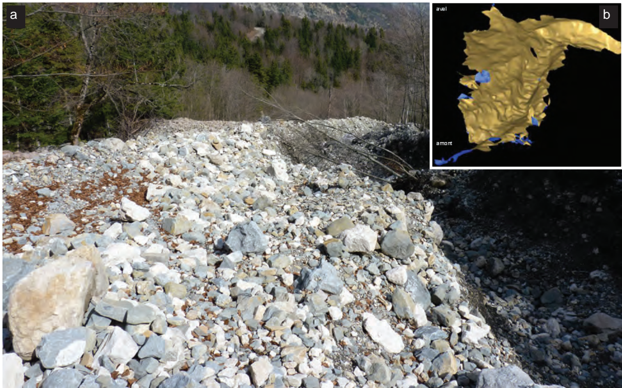
Figure 4 - Traitements du nuage de points pour le passage au MNT de la Glacière (2009) : a) vue d'une partie du site ; b) maillage 3D.
