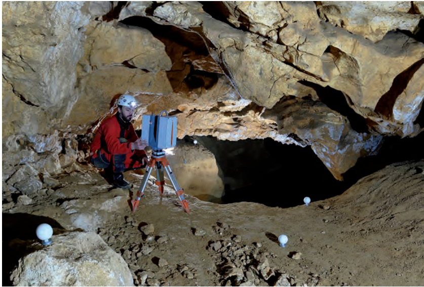
Photo 4 - Mise en œuvre d'un scanner 3D courte portée (Leica HDS 6000) avec référencement local par des sphères (Photo Stéphane Jaillet).
