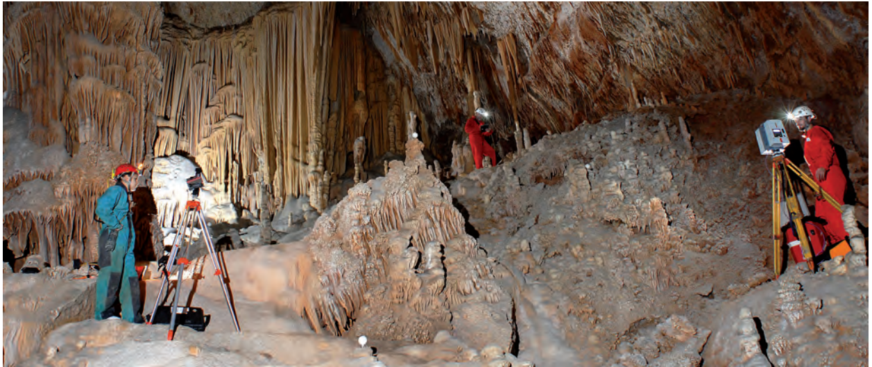
Photo 2 - Acquisition lasergrammétrique du modèle 3D des spéléothèmes dans la grotte de Jeita. Un scanner HDS 6000 est ici mis en œuvre (à droite). Des sphères servent à la consolidation des scènes et un référencement local est réalisé avec un compas électronique couplé à un distance-mètre (à gauche) (Photo Stéphane Jaillet).
