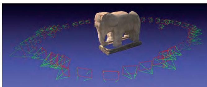
Figure 3 - Exemple des « nouveaux » protocoles d'acquisition utilisés en photogrammétrie numérique. Ci-dessus, planche des 66 images utilisées pour acquérir le modèle de l'éléphant ; à droite, position des caméras.
