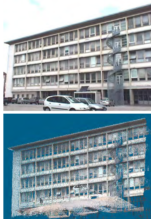
Figure 4 - Photo d'une façade de l'INSA de Strasbourg et nuage de points correspondant.
