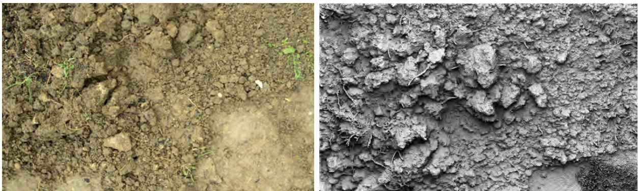
Figure 12 - Photo de sol et modèle 3D utilisé pour des calculs de rugosité.
