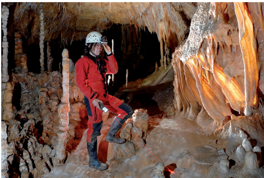
Photo 3 - Matériel de topographie classique en spéléologie : main gauche, un compas (ici couplé à un clinomètre) pour la mesure des angles (direction et pente) et main droite, un distance-mètre laser pour la mesure des longueurs. La précision angulaire est de l'ordre du demi-degré, celle des longueurs est centimétrique et la précision du positionnement des stations est décimétrique (Photo Stéphane Jaillet).
