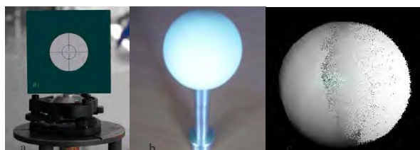
Figure 15 - Types de cibles employées avec le scanner Trimble GX ; de gauche à droite : cible plane ; sphère ; sphère modélisée sur la base du nuage de points la couvrant.
