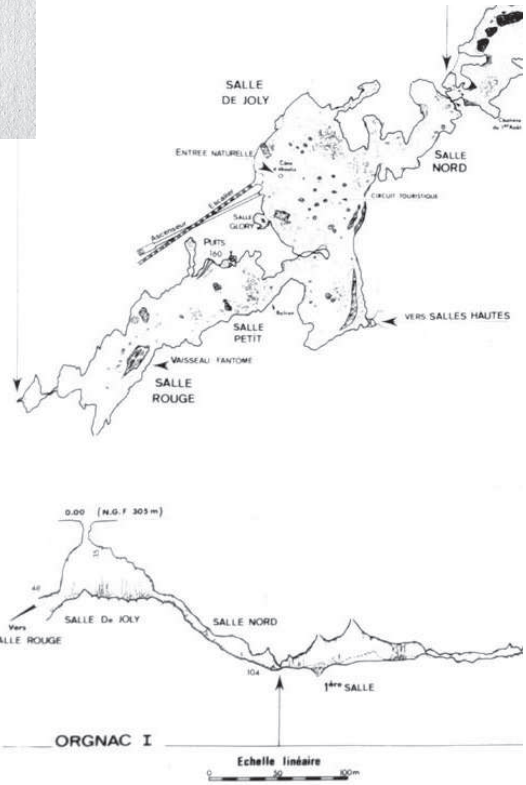
Figure 7, ci-dessus - Le plan d'Orgnac I dans la synthèse topographique de l'ensemble des réseaux Orgnac-Issirac (finalisée en 1966). Noter l'absence des salles Hautes. De même, la coupe de la partie sud des réseaux (Salles Rouges) fait défaut. Cependant les salles Nord sont enfin correctement topographiées (voir aussi Figure 23, le document qui précède cette mise au propre).
