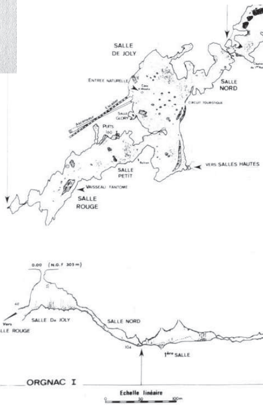
Figure 7, ci-dessus - Le plan d'Orgnac I dans la synthèse topographique de l'ensemble des réseaux Orgnac-Issirac (finalisée en 1966). Noter l'absence des salles Hautes. De même, la coupe de la partie sud des réseaux (Salles Rouges) fait défaut. Cependant les salles Nord sont enfin correctement topographiées (voir aussi Figure 23, le document qui précède cette mise au propre).
