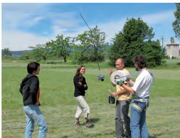
Figure 4 - Matériel utilisé : en haut, le cerf-volant utilisé, un delta mono-fil, stable pour ce type d'usage et piloté par un opérateur (à droite), équipé d'un baudrier et d'un enrouleur ; en bas, montage du dispositif de prise de vue aérienne, Appareil Nikon CoolPix P6000 installé sur une nacelle simple. Le déclenchement des prises de vues est assuré par une télécommande.
