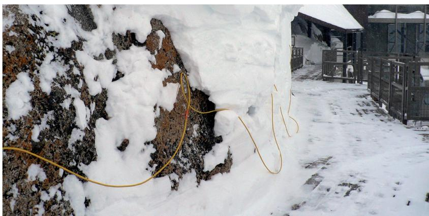
Figure 7 - Mesure de tomographie électrique résistive sur la face est du Piton central de l'Aiguille du Midi en décembre 2008.
