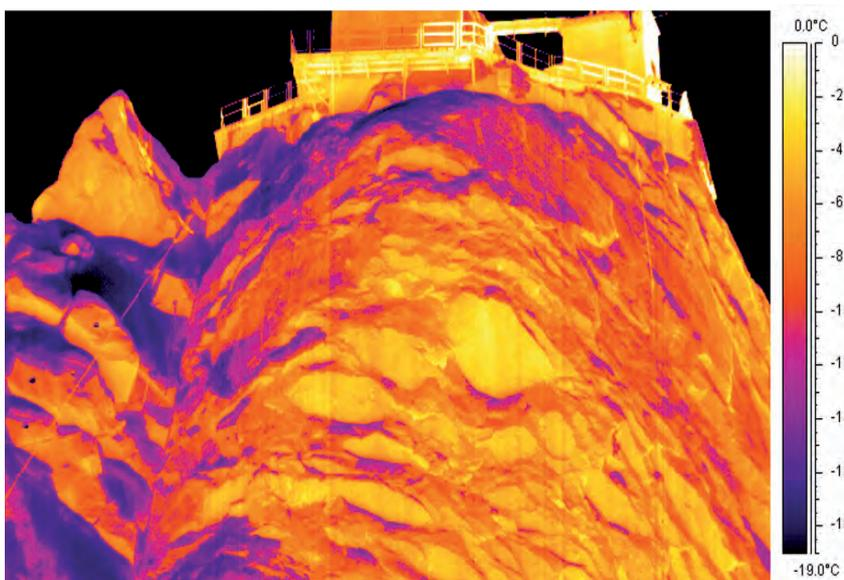
Figure 8 - Image thermographique infrarouge de la face nord du Piton central de l'Aiguille du Midi (05/04/2007) ; température de surface comprise entre  $-2^{\circ}C$  et  $-19^{\circ}C$ .
