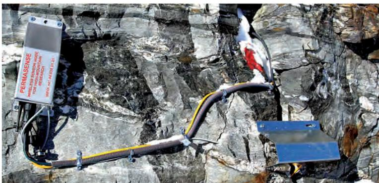
Figure 8 - Mesure de la température de la roche et de l'ouverture d'une fissure par un réseau de capteurs sans fil (prototype) dans la niche d'éroulement de 2003 sur l'arête du Hörnli (Cervin, 3400 m). Bien que les mesures restent difficiles à mettre en œuvre dans la plupart des types de terrains à permafrost, de nouvelles technologies permettent de réduire l'effort à fournir pour l'acquisition des données et l'entretien des instruments ([www.permasense.ch](http://www.permasense.ch)).
