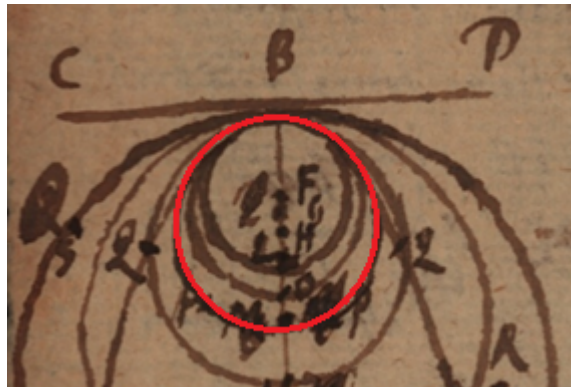
Fig. 8 : Le cercle tangent de rayon BH est le cercle osculateur de la parabole QBQ et l'angle d'osculution est l'angle PBQ
