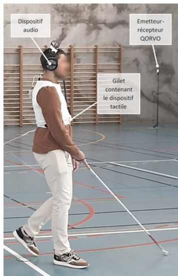
Figure 5. Participant non-voyant suivant un itinéraire virtuel guidé par le dispositif audio et le dispositif tactile.
