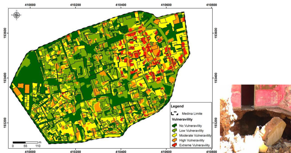
Figure 6 - Carte de la vulnérabilité aux effondrements de la médina de Beni Mellal (source : Wafik et al., 2023) et effondrement d'une maison dans la médina le 27/01/06 avec un bilan de 2 morts.
