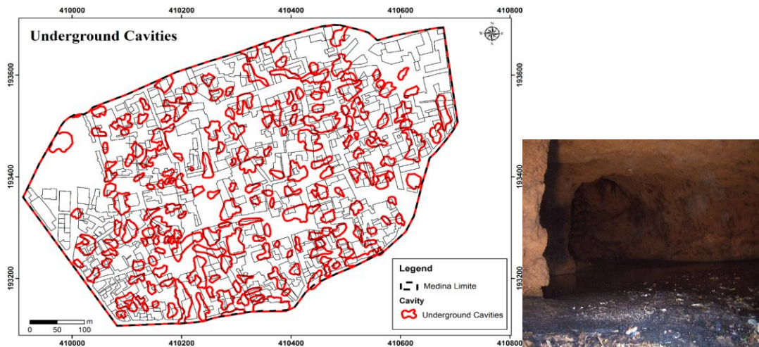
Figure 5 - Carte des cavités souterraines de la médina de Beni Mellal par investigations géophysiques (source : Wafik et al., 2023) et cavité remplie d'eaux usées et ordures.
