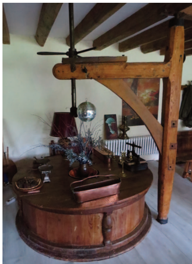
Fig.4,D : Le coffre en bois protégeant les meules (dormante et tournante) avec sa potence d'entretien.
