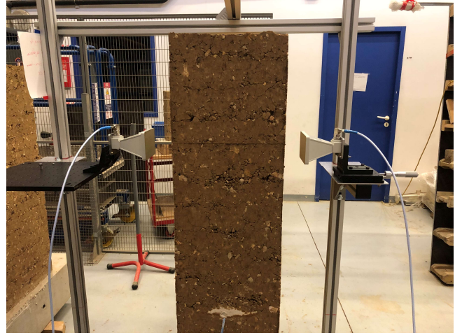
Figure 2 : Banc de mesure « in-situ » des murs en pisé.
