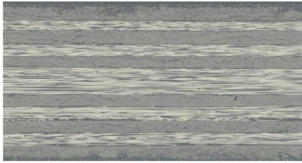
Empilement : [0,90]_{3S} + film d'enrichissement 60 \mu\text{m} . (LM-PAEK TC1225)
