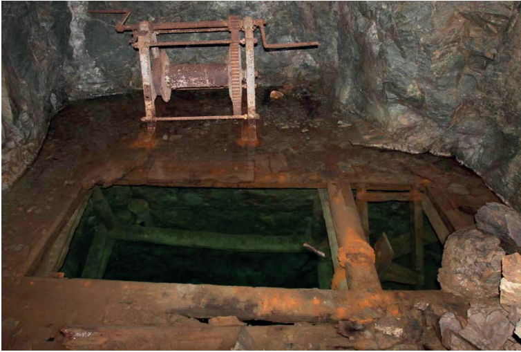
Figure 7 : puits immergé de la mine de Boussuivre (Joux, 69) (Cliché : G. Bonnamour).
