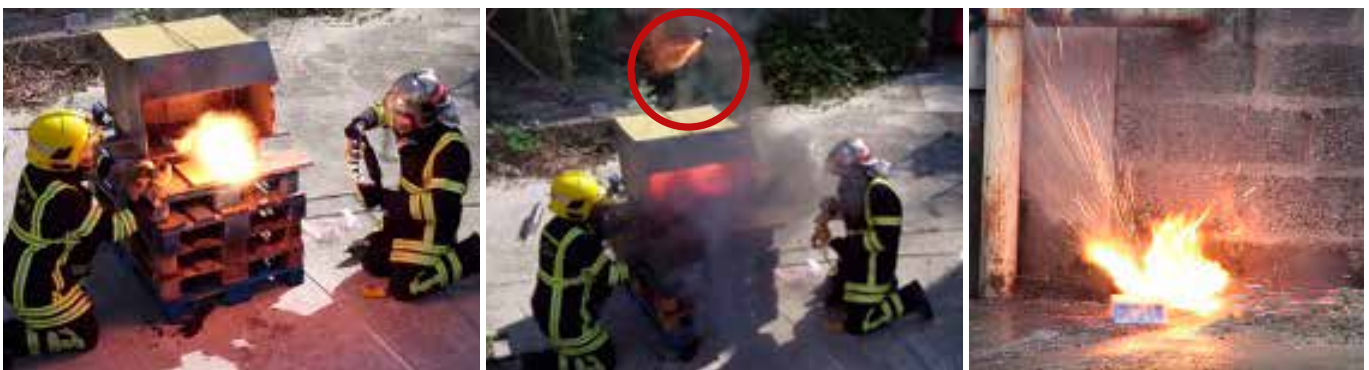
Figure 52 : Projection d'éléments métalliques solides observés lors du brûlage d'un stockeur de 30Wh
