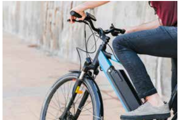
Vélo électrique (36 V, 13,9 Ah, 2,7 kg)
