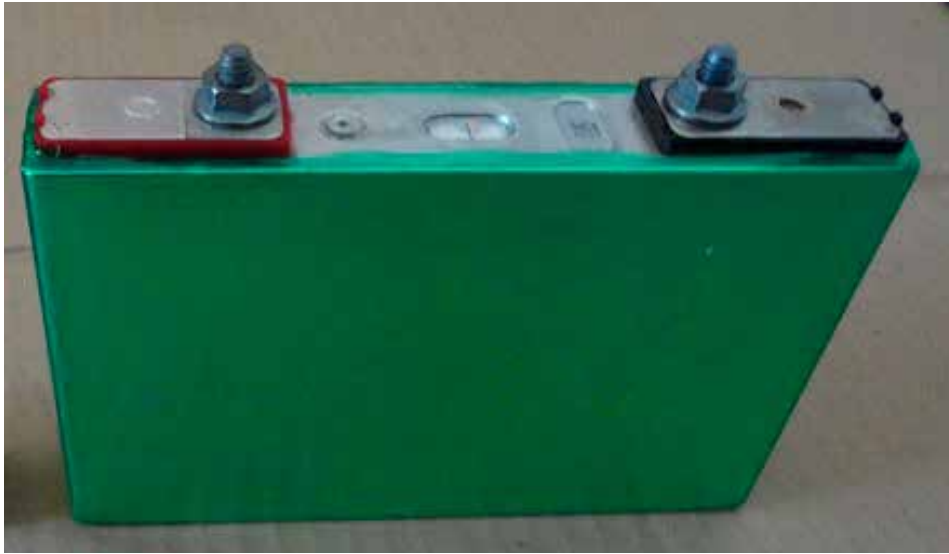
Figure 43 : photo d'une cellule utilisée dans l'assemblage du module.
