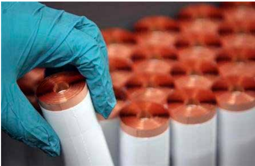
Figure 6 : Exemple de cœurs électrochimiques d'accumulateur Li-ion obtenu par bobinage.
