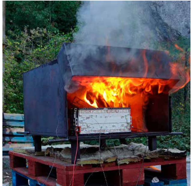
Figure 44 : photos du module lors de l'essai d'agression thermique.
