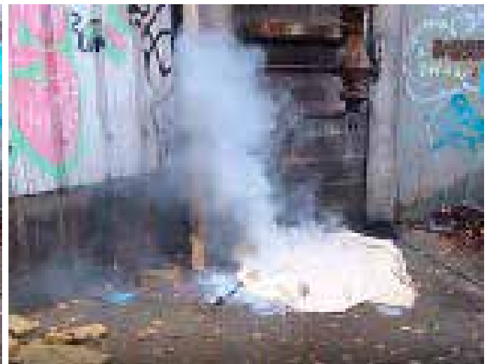
Figure 61 : Tentative d'extinction d'un stockeur au moyen d'une couverture anti-feu et génération des fumées blanches froides
