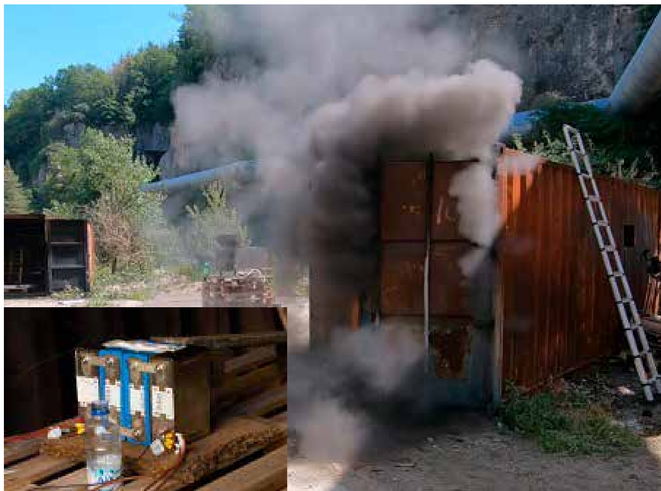
Figure 54 : Explosion de fumées lors d'une surcharge de 4 cellules LEV75 dans un caisson maritime de 6 mètres
