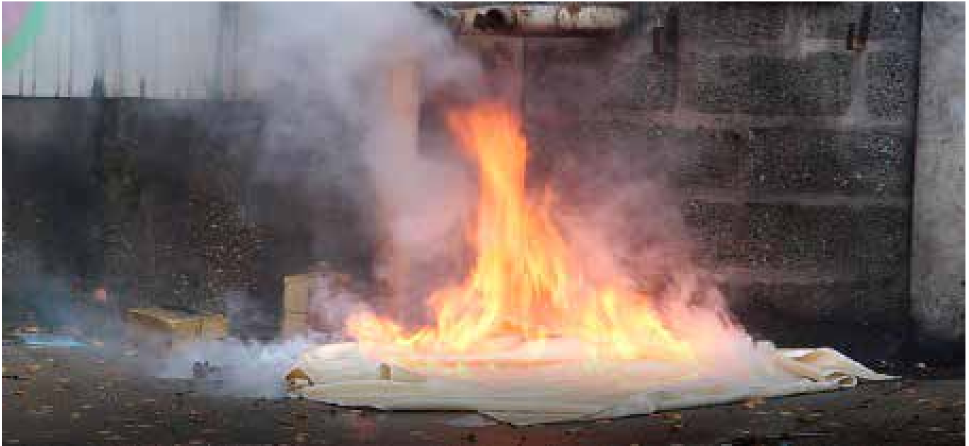
Figure 51 : Inflammation des fumées blanches sur pack NMC de 500Wh.
