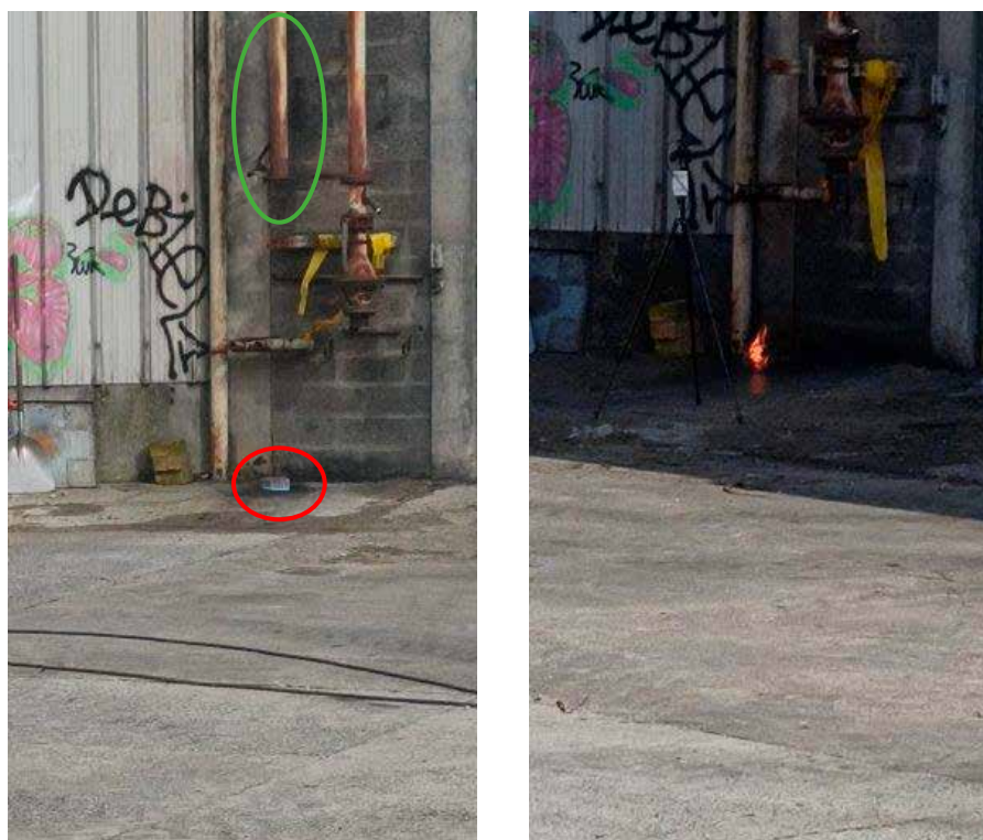
Dispositif mis en place pour tester les batteries quart de lune au choc A gauche, en rouge la batterie et en vert le conduit par lequel arrive la boule de pétanque A droite, caméra thermique placée devant la batterie en combustion suite au choc
