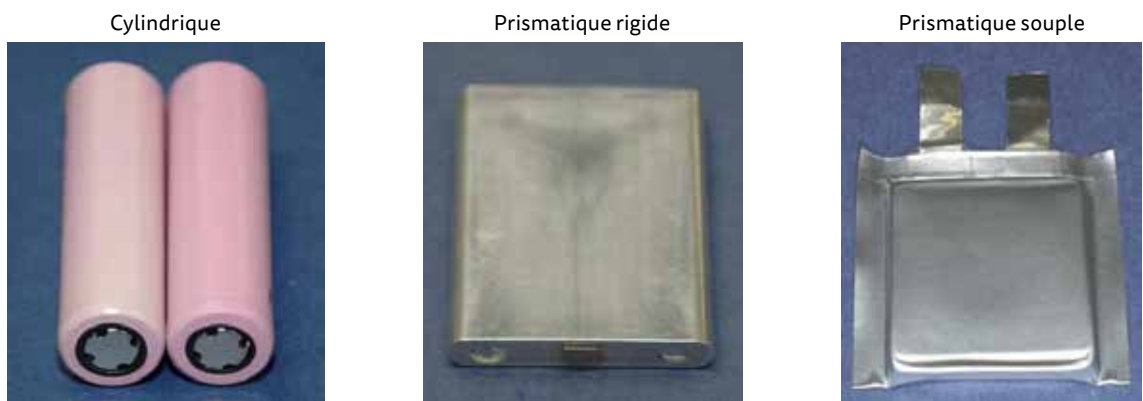
Figure 12 : Exemple de photo des trois types d'emballages de cellules Li-ion
