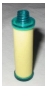
Figure 8. Corps diffusif Radiello® pour les COV (passif) (code 120-2).
