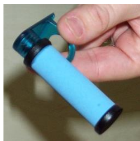
Figure 10. Corps diffusif Radiello® pour les aldéhydes (code 120-1).
