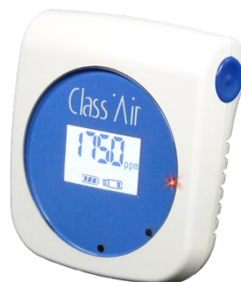
Figure 5. Class'Air (version 2) pour la mesure du CO 2 développé au CSTB.
