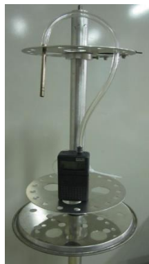
Figure 9. Prélèvement de COV par tube Tenax TA avec une pompe SKC Pocket
