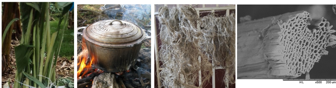
Fig. 1. Nervures de bananier/cuisson à l'eau/fibres extraites lors du séchage/coupe MEB d'une fibre FYC
