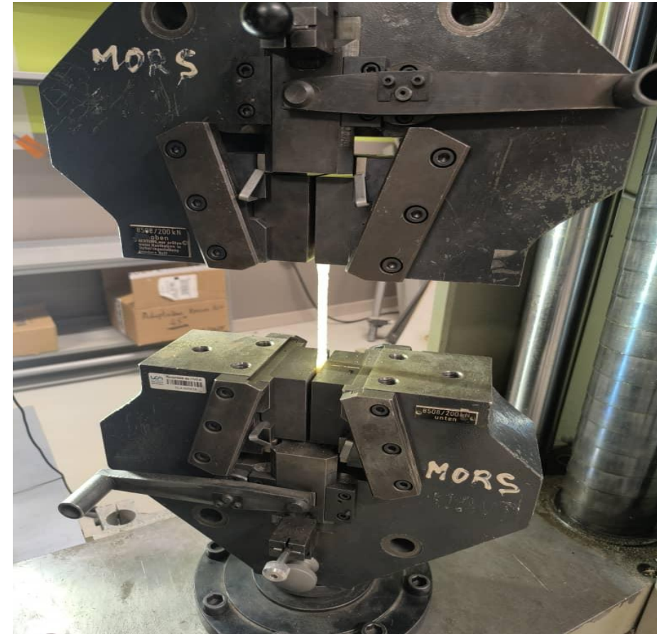
Fig 7 : Essai de traction avec machine universelle 250KN
