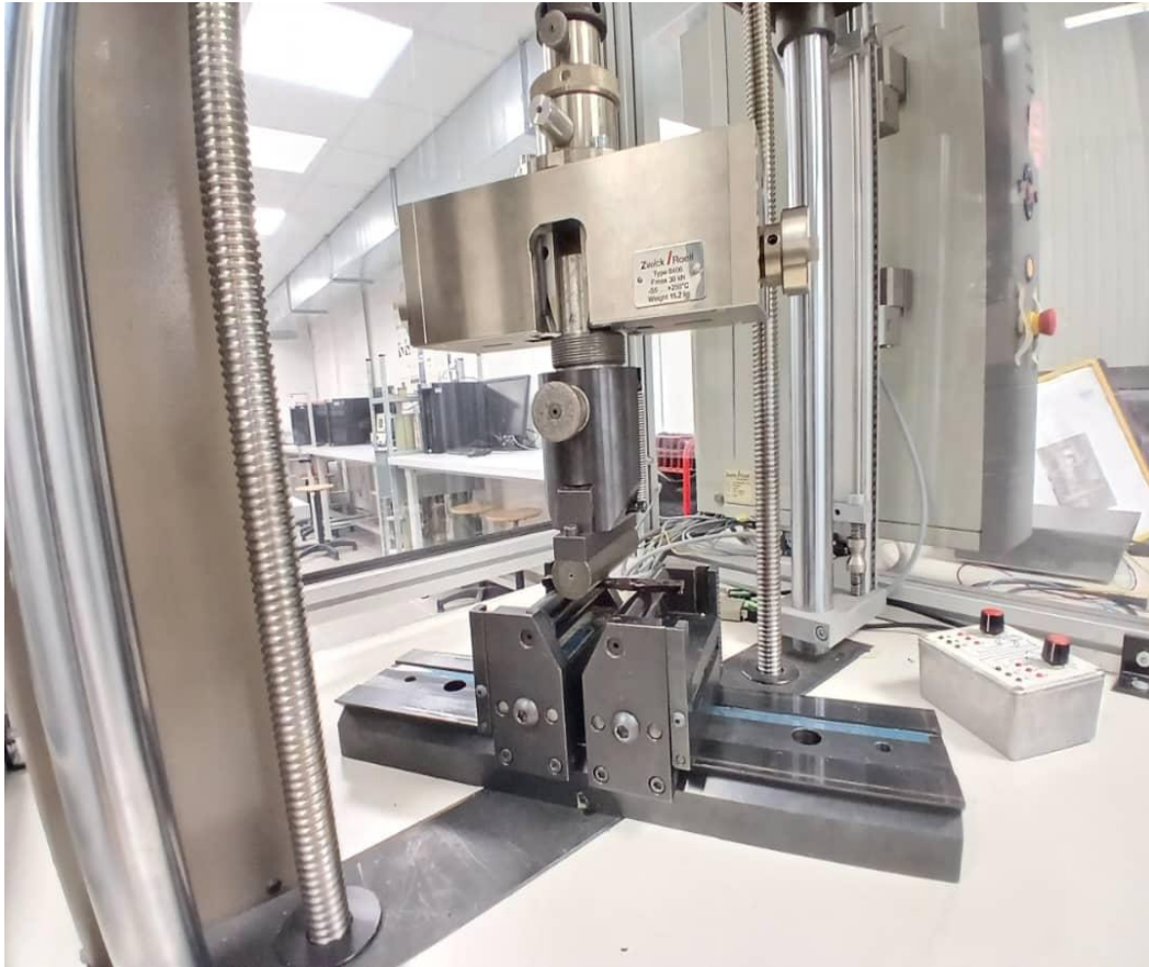
Machine universelle de 20KN
