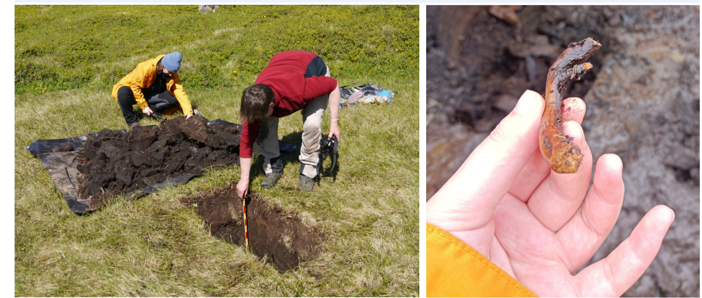
Une fois la fosse creusée, la stratigraphie est relevée et les éléments à dater prélevés. Ici, échantillon de Betula sp. prélevé au fond de la fosse (© D. Mercier, & E. Portier, 2022). Une fosse intra-glissement post-date le glissement, une fosse en amont date le piégeage sédimentaire.
