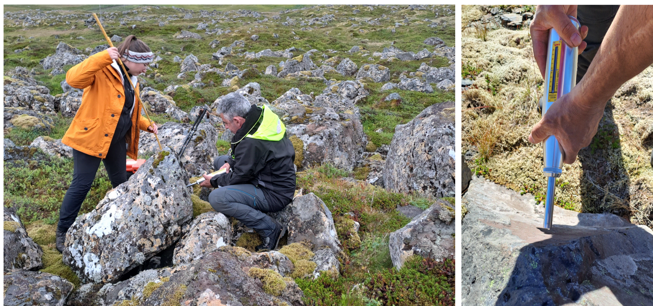
Mesures au marteau Schmidt sur le terrain selon la méthode de Matthews et Winkler (2022). 5 mesures par bloc, 30 blocs par site. Plusieurs sites par glissement, selon les unités géomorphologiques. La morphométrie de chaque bloc est relevée (© A. Decaulne, 2023)
