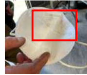
Photo 2 - Contamination intérieure masque FFP2 après le port
