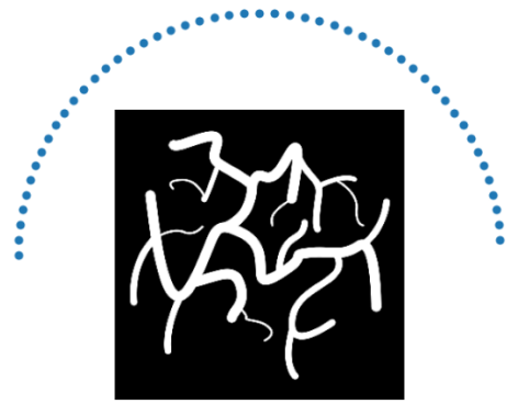
FIGURE 3 : Géométrie du fantôme d'imagerie numérique et position des capteurs (en bleu).
