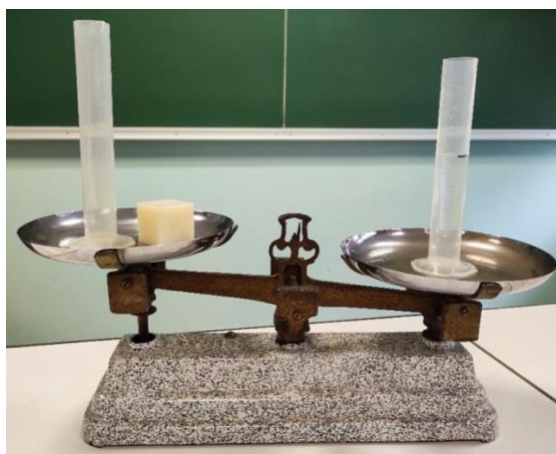
Figure 4 : comparaison de la masse d'un solide en nylon à celle d'un même volume d'eau saturée en sel
